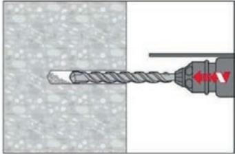
Percer le trou à la profondeur requise avec une mèche creuse Hilti TE-CD ou TE-YD de taille appropriée connectée à un aspirateur Hilti. Cette méthode de perçage nettoie correctement le trou et élimine la poussière pendant le perçage.
