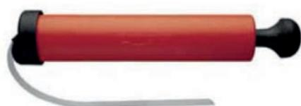
**Nettoyage manuel (MC) :** Pompe soufflante manuelle Hilti pour nettoyage de trou de diamètre  $d_0 \leq 20$  mm et longueurs de scellement  $h_0 \leq 160$  mm
