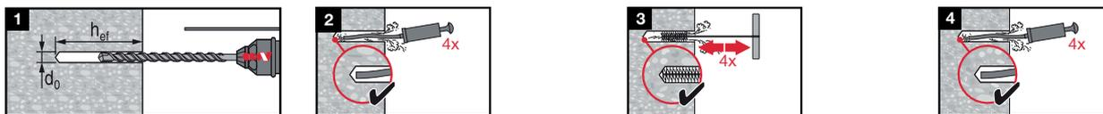
Nettoyage à air comprimé (Tous diamètres et toutes profondeurs de trou)
