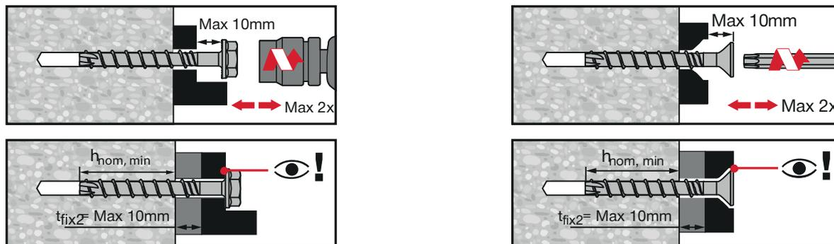
Seules les vis listées dans les tableau ci-dessous peuvent être ajustées avec les profondeurs d'implantation et épaisseur de pièce à fixer indiquées.
